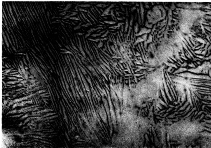
Abb. 1. \text{Nb}_{70.0}\text{Al}_{30.0} , ungetempert; Phasengemisch A15 (dunkel) — \sigma (hell), entstanden beim Abkühlen primär kristallisierter A15-Phase; 500-mal.
